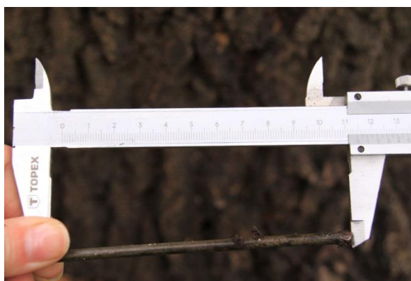
Fot. 9. Pomiar głębokości otworu nr 2.
